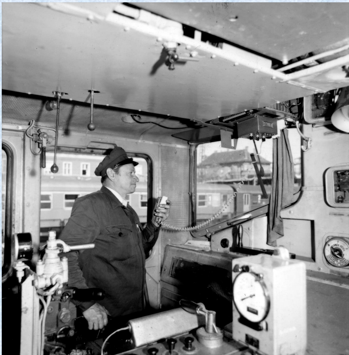
144. kép: rádiót szereltek a felújított V42-esekre is. MÁV archívum X20246828
