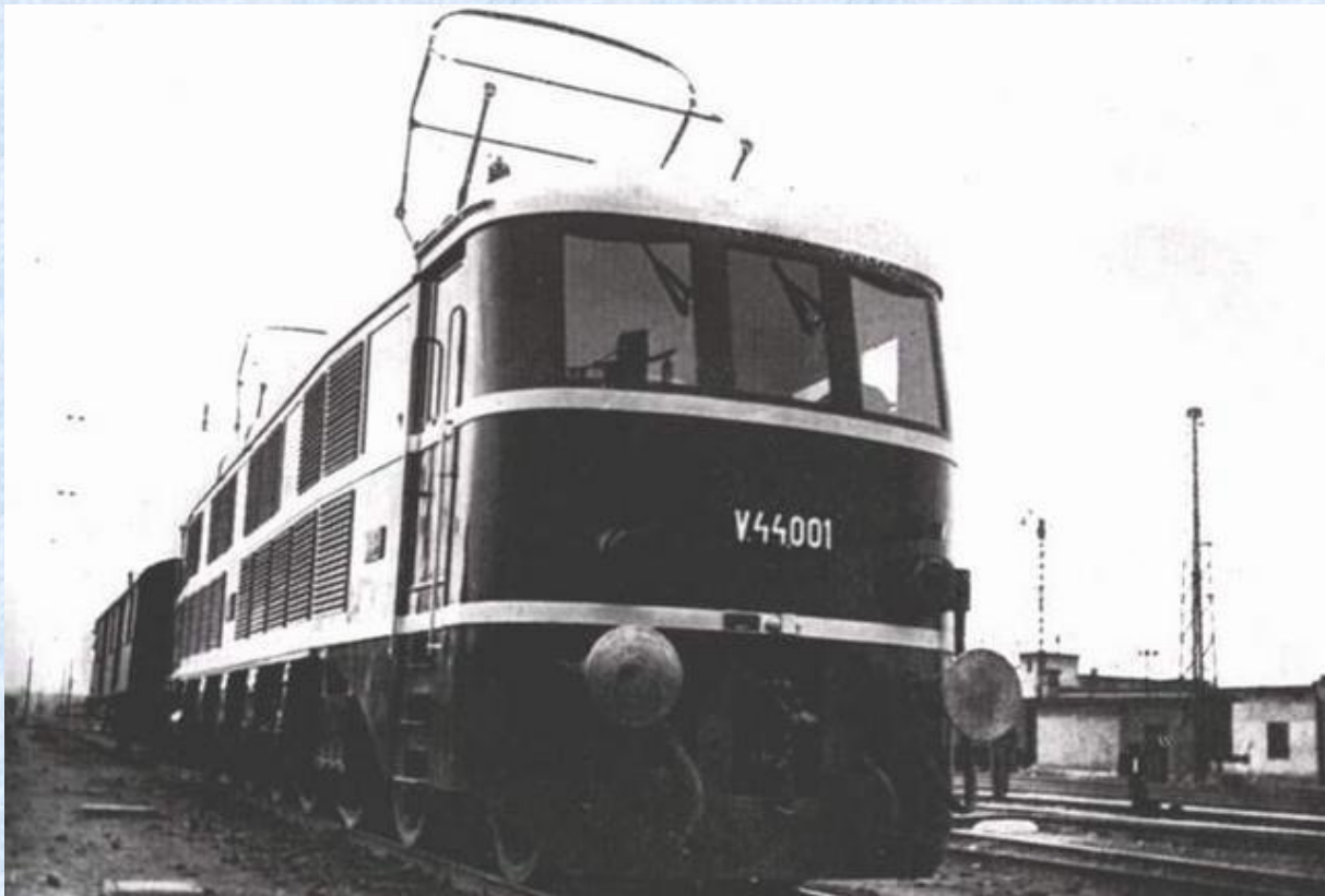
40. kép: a fázis-periódus váltós „Radony” Józsefváros állomáson, átvételi próbára készen.
