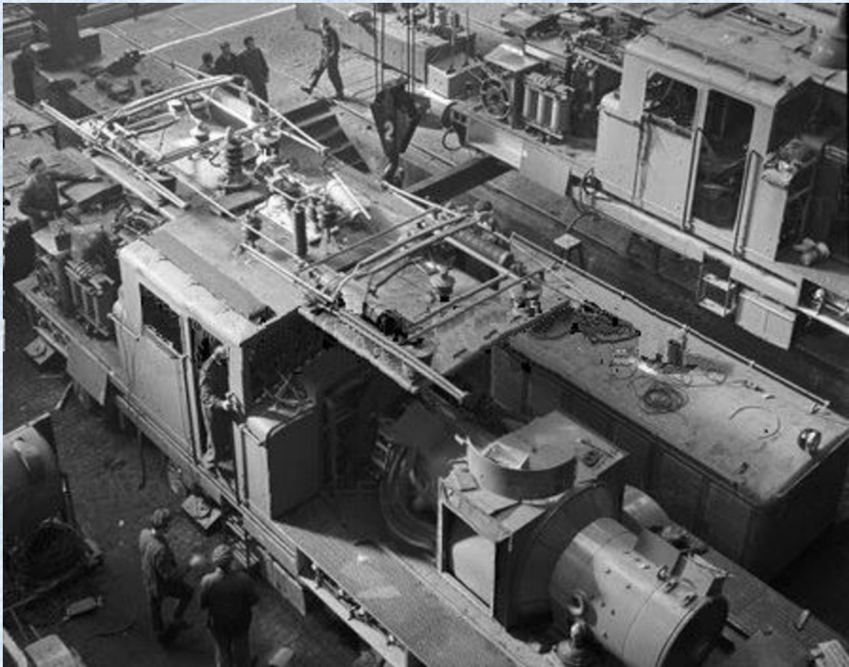
50. kép: gyártás alatt a Ganzban a V41-esek első szériája. Fotó: Lajos György
