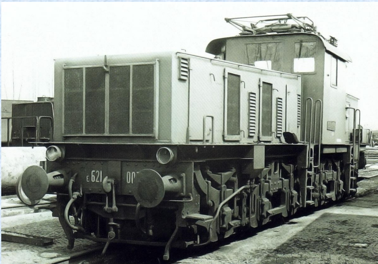
220. kép: egy furá rokon, a metadin forgógépes E621 005. 1947-ben készült.
