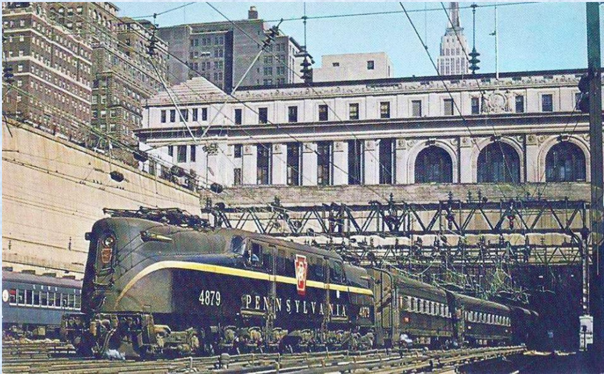
16. kép: A Pennsylvania Railroad csökkentett periódusú táplálást használt, a híres GG1-esek kommutátoros motorokkal, fokozatkapcsolós trafóval működtek. A 4879-es a Penn Stationt hagyja el egy washingtoni expresszel.
