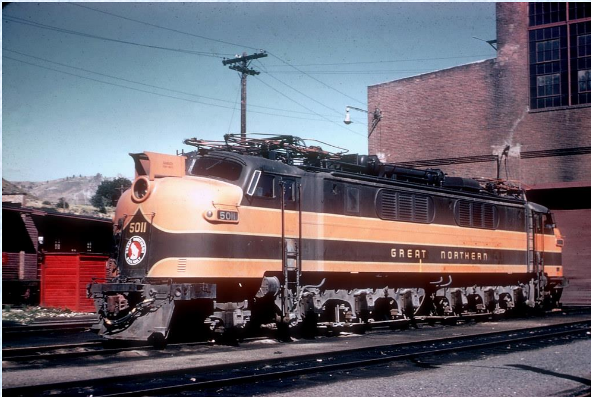
199. kép: az 5011-es egyedi volt, mert egy 1945-ös balesetben teljesen összetört, ezért kapta ezt a szép áramvonalas gúnyát.
