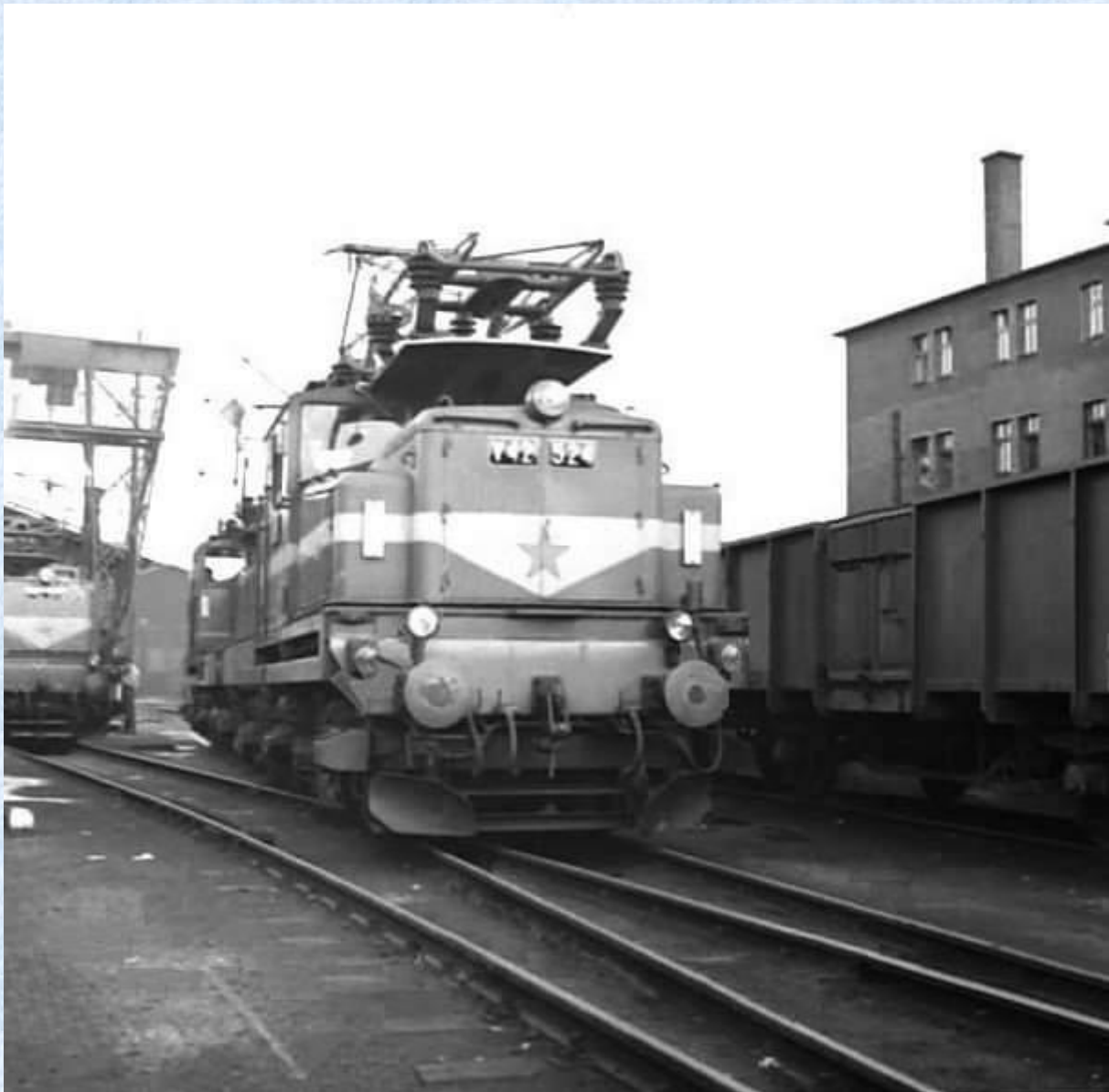
313. kép: a V42 524-es a Keleti pu. fűtőháza előtt állt 1966 június 25.-én. Az alig két éves mozdonyon még minden újszerű, a fényezés, a fűtési kábel és a távvezérlési csatlás aljzatai is a helyükön vannak. Ez volt a második darab a VM12.4-es szériából, így már ezen is AOP317-es áramszedő van, és a forgóvázak már görgős csapágyakkal készültek. Vitályos József felvétele.
