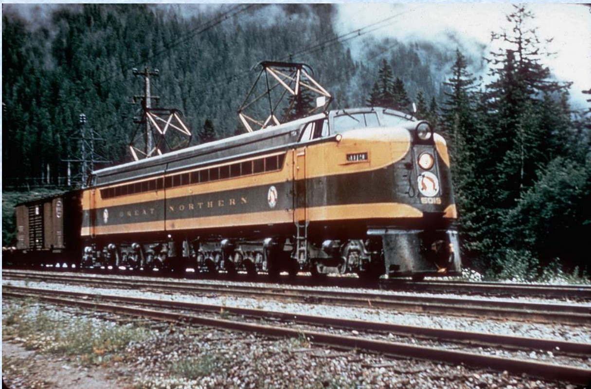
202. kép: az 5018-as, W sorozatú gép tehervonattal a festői tájon. A W volt a WL-mozdonyok Gigantja, 5000 lóerő teljesítménnyel. Az állandó teljesítménye volt akkora, mint a V63-as órás teljesítménye! Két gépcsoportja van, és 12 motorja. Kár, hogy csak kettő készült belőle, és ma már egy sincs meg.
