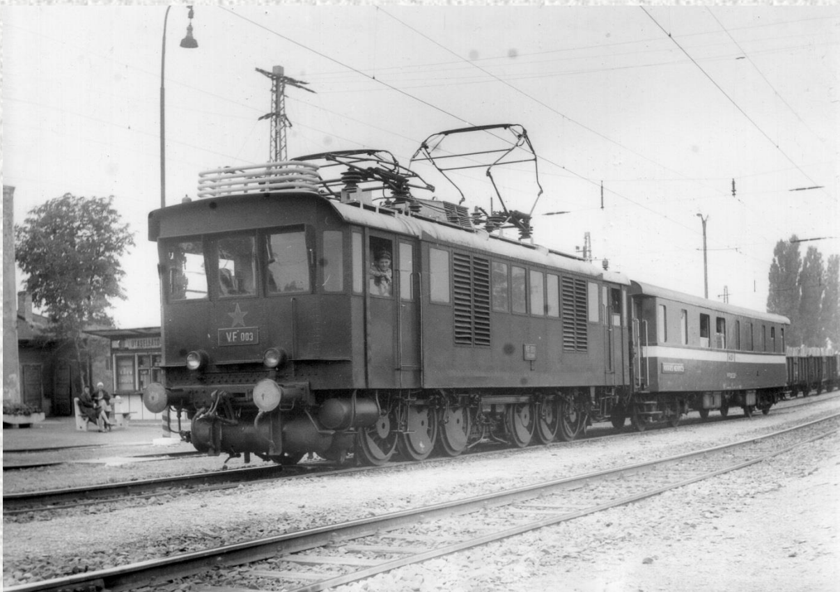
A 003-as, mint fékmozdony a 152-es vontatási mérőkocsival Horvátkimlén.
