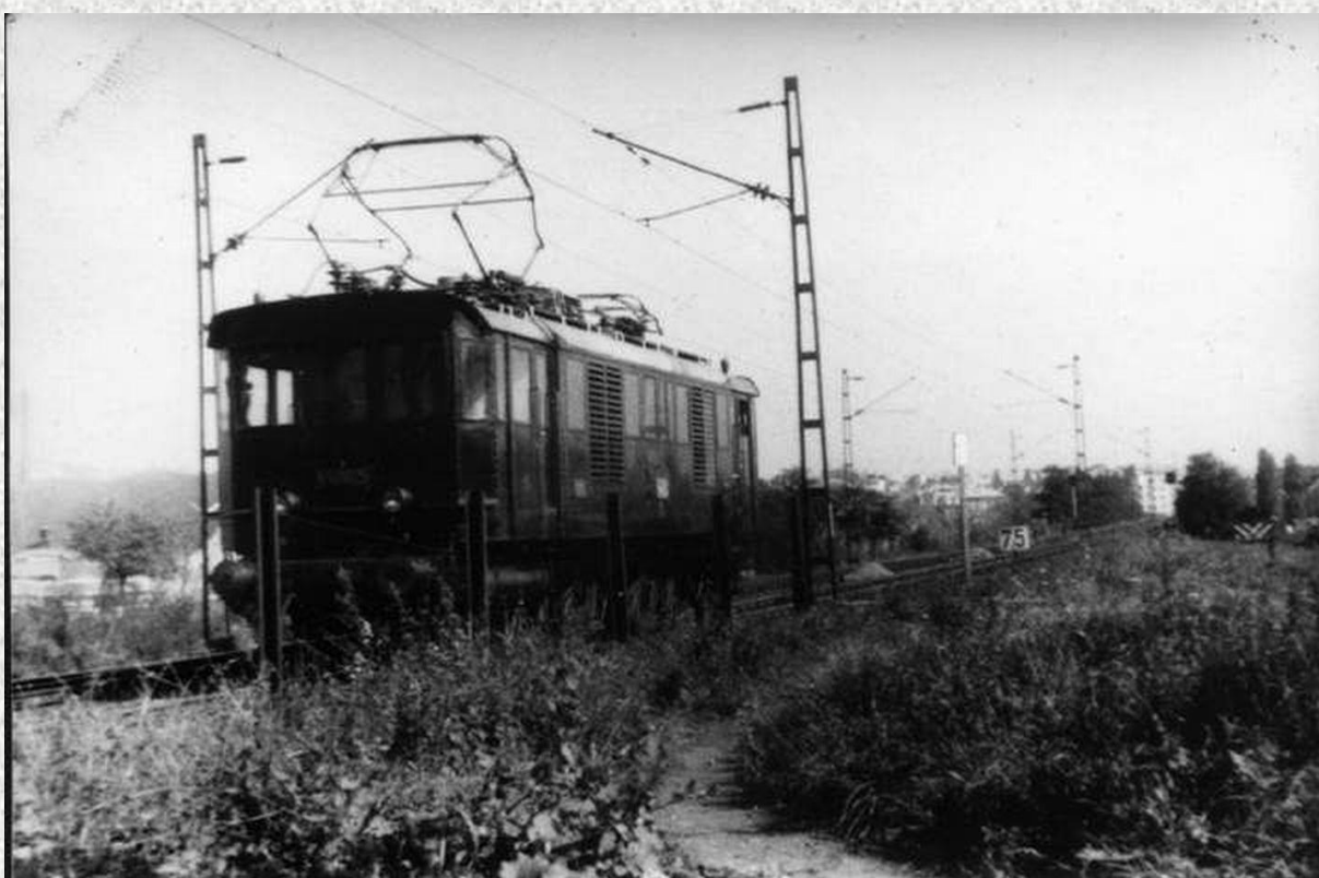
A 025-ös szedi a lábát a susnyás szélén, Kelenföld kijáratánál. A Kandók a körvasúton is sokat jártak, 1961-ig Füzesabonyig is közlekedtek, 1962-től lett 25 kV-s a miskolci vonal.
