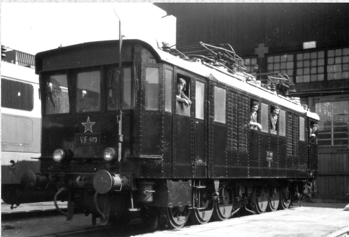
1967-es selejtezése után a V60 003-ast átminősítették, és mint villamos fékmozdonyt használták egy vontatási mérőkocsival, hogy meghatározhassák
