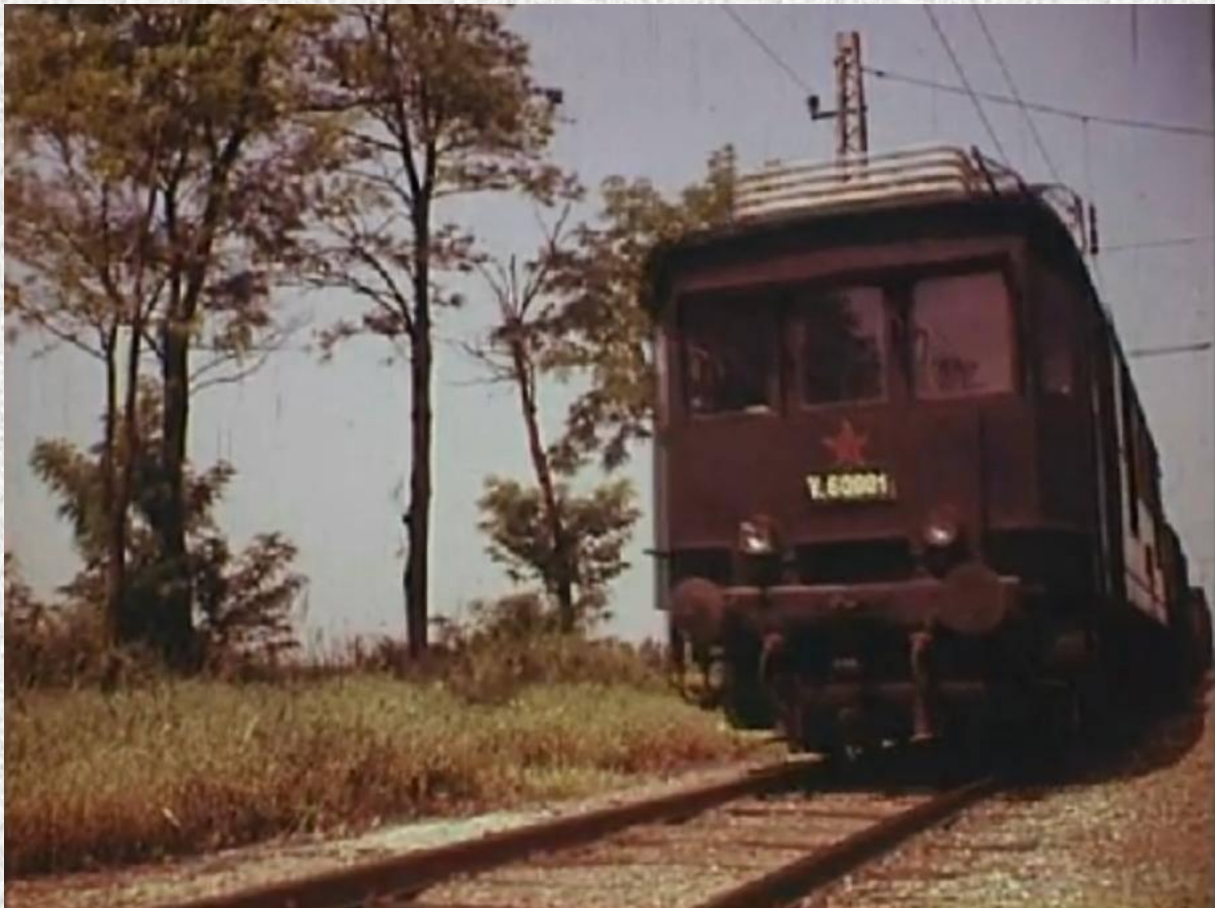
V60 001 tehervonattal, valahol Győr után. A gép tetején ott kígyózik a hűtőcső, mely a fázisváltó vizét hűti a menetszél által.
