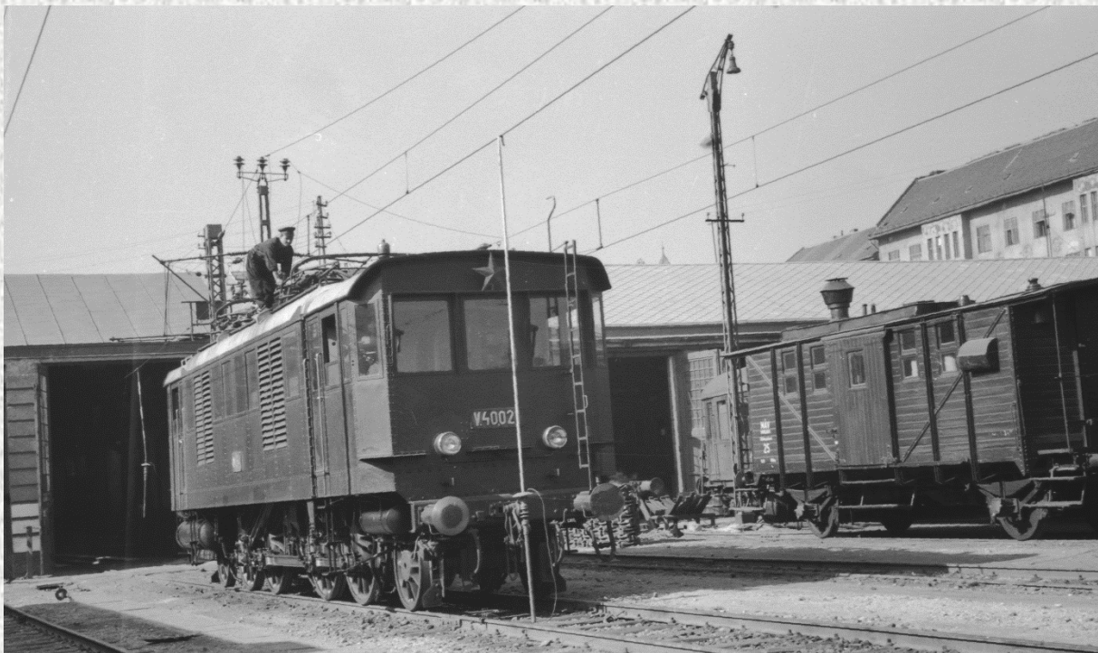
A 21-es napi vizsgán a Keleti régi villanyszínjében. A felsővezeték gondosan ki van szakaszolva, és le van földelve, a 16 kV nem játékszer.
