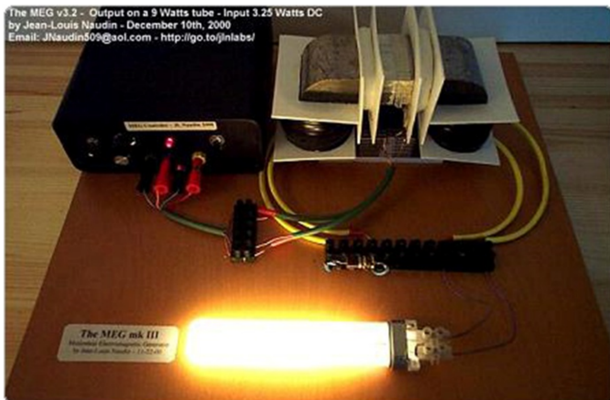
9. ábra. A M.E.G. készülék egyik kimeneti tekercsének a terhelése egy 9 W-os fénycső (fent)
