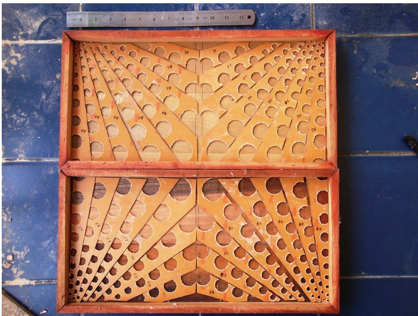
A platform egy utánépített változata. Jól látható a doboz belsejében elhelyezett ék alakú, félkörösen befűrészelt lapkák rendszere, szabályos geometriai formába rendezve.
