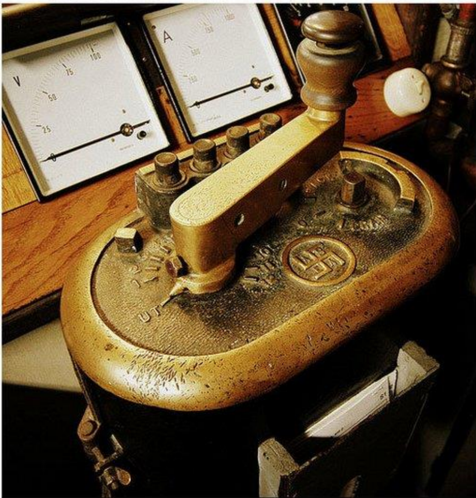
Egy 1913-as ASEA villamos motorkocsi menetkapcsoló szekrényén is ott van!
